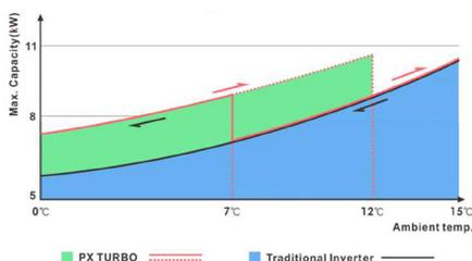
Le mode **POWERFULL** permet de booster la performance de la PAC de 20 à 30% comparé à une inverter classique, principalement lorsque la température extérieure est comprise entre 0 et 12°C.
